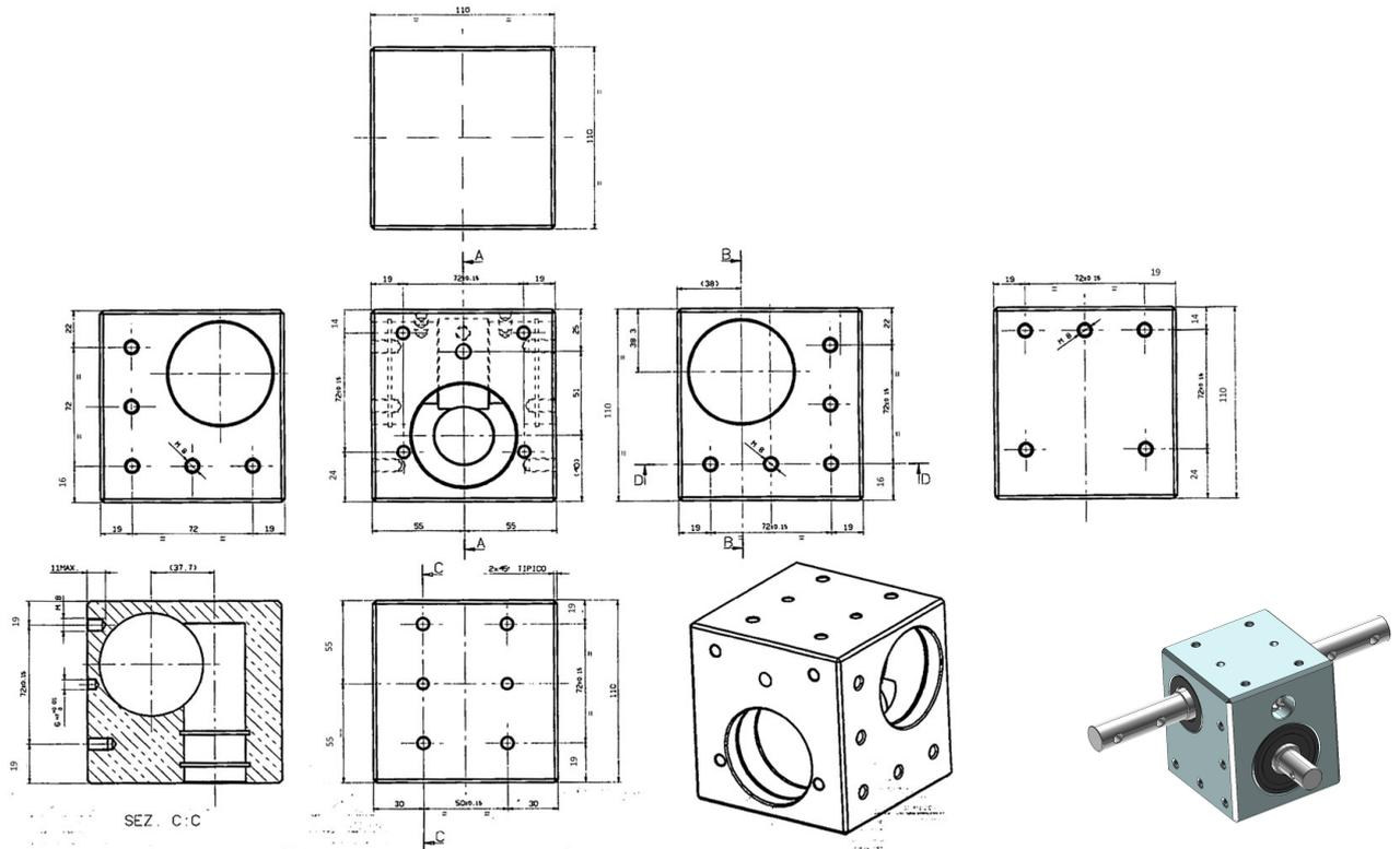
Riduttore manuale non reversibile ad uno stadio di vite e corona idoneo per azionare finestre in serre, stalle, capannoni
