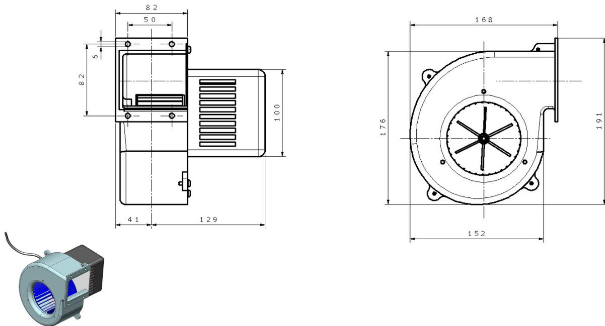
Ventilatore centrifugo per il gonfiaggio del doppio telo nei tunnels Ventola e coclea in alluminio
