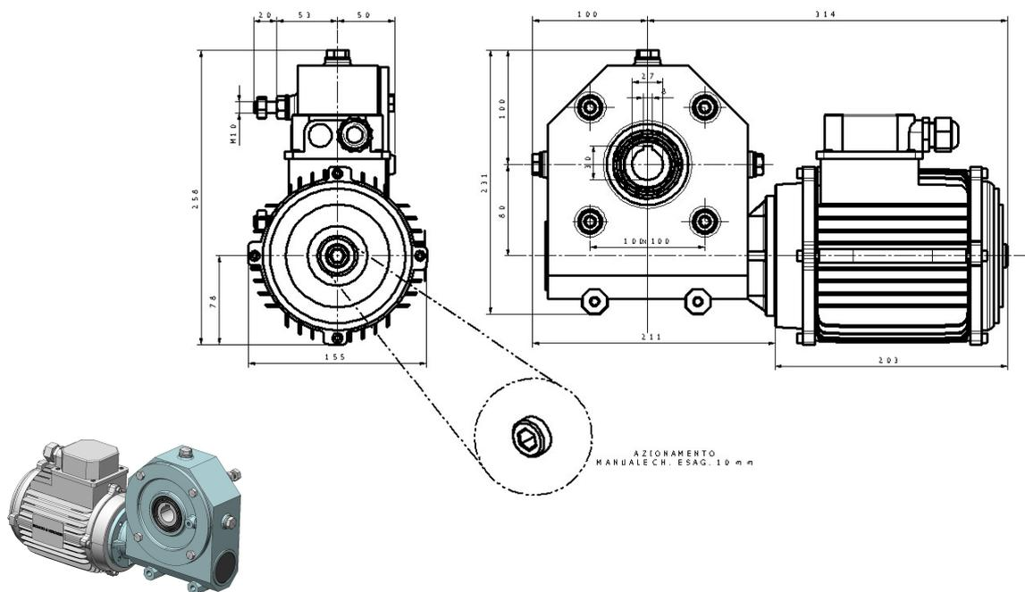
Motoriduttore non reversibile ad uno stadio di vite e corona. Idoneo per azionare finestre in serre, stalle, capannoni e impianti di movimentazione schermi dove è richiesta una velocità oltre i 10 giri/minuto.
