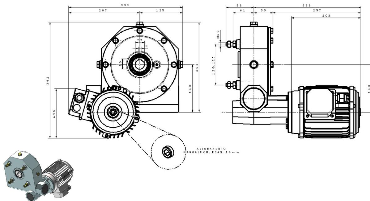
Motoriduttore non reversibile a due stadi di vite e corona. Idoneo per azionare finestre in serre, stalle, capannoni e impianti di movimentazione schermi.
