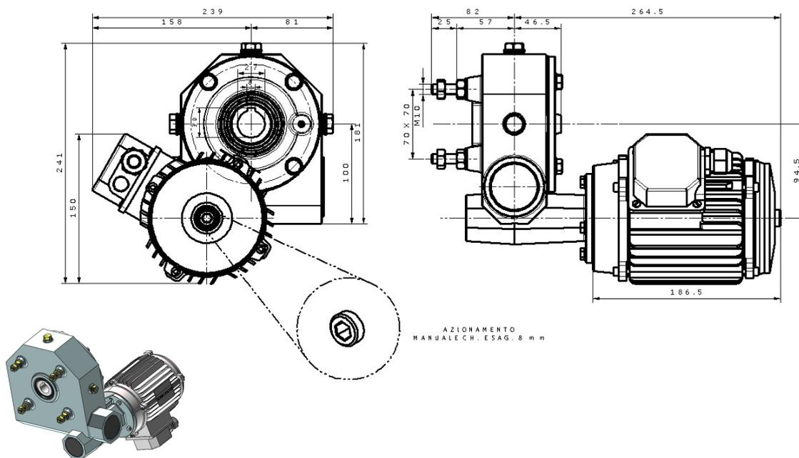
Motoriduttore non reversibile a due stadi di vite e corona. Idoneo per azionare finestre in serre, stalle, capannoni e impianti di movimentazione schermi.
