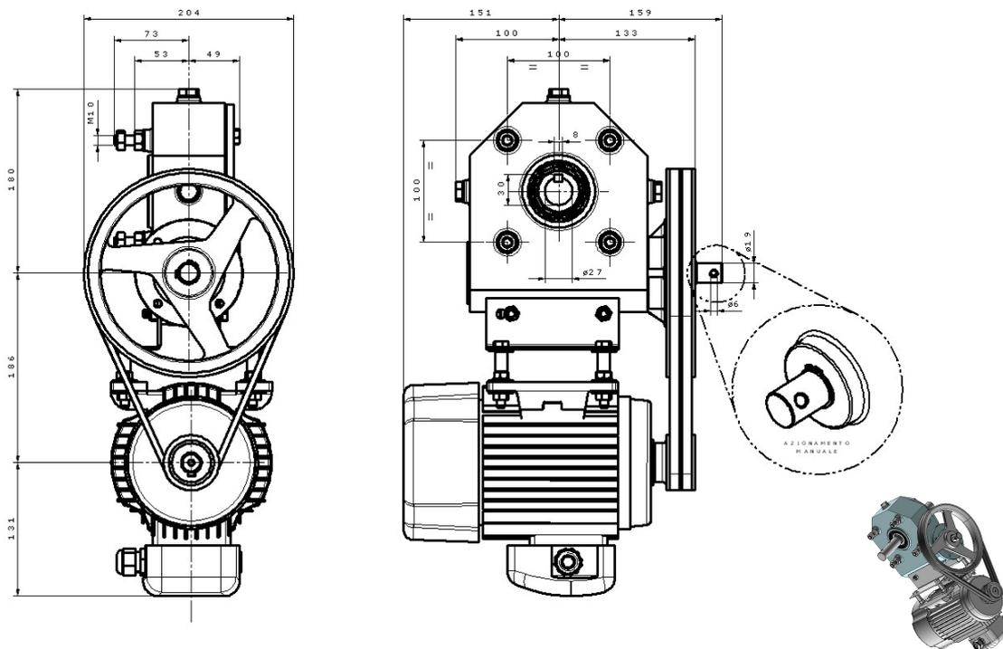
Motoriduttore non reversibile ad uno stadio di vite e corona con pulegge. Idoneo per azionare finestre in serre, stalle, capannoni e impianti di movimentazione schermi.
