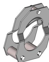
Cuffia per cremagliera, realizzata in acciaio zincato Sendzimir. Nottolini di guida rotanti in materiale termoplastico autolubrificante. Applicabilità su aste dritte C0468 e curve C0584.
