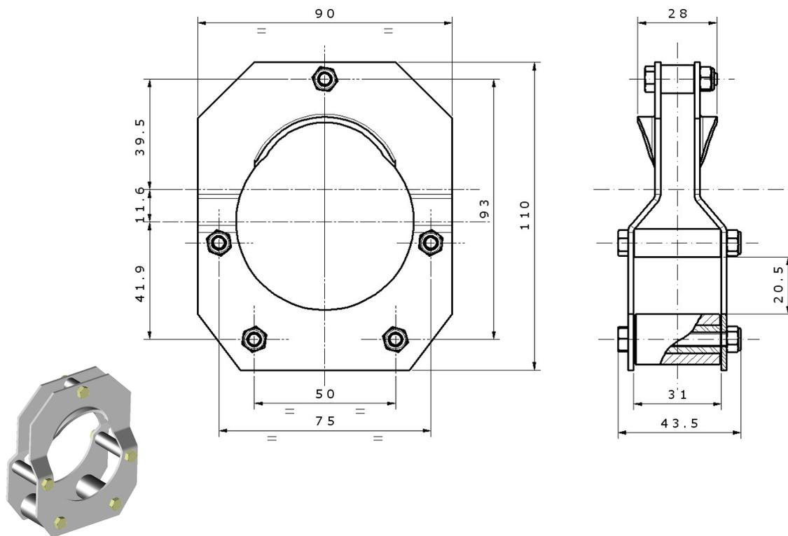
Cuffia per cremagliera, realizzata in acciaio inox AISI 304. Nottolini di guida rotanti in materiale termoplastico autolubrificante. Applicabilità su aste inox : C1037, C1038.
